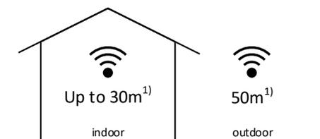
CASAMBI utilise la technologie de réseau MESH. Chaque appareil se comporte comme un répéteur et rafraîchit le signal Bluetooth reçu pour les appareils suivants.
