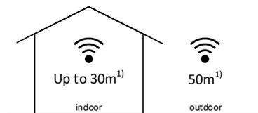
CASAMBI utilise la technologie de réseau MESH. Chaque appareil se comporte comme un répéteur et rafraîchit le signal Bluetooth reçu pour les appareils suivants. Des portées plus importantes peuvent donc être obtenues avec d'autres appareils CASAMBI.
