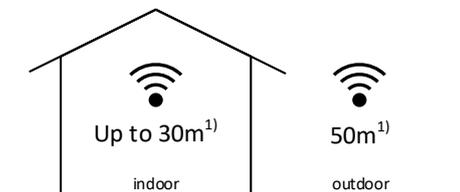
CASAMBI utilise la technologie de réseau MESH. Chaque appareil CASAMBI se comporte comme un répéteur et rafraîchit le signal Bluetooth reçu pour les appareils suivants.
