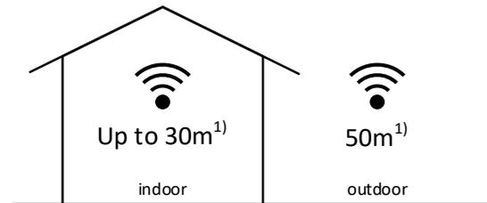
Casambi verwendet die MESH Netzwerk-Technologie. Jedes Gerät verhält sich wie ein Repeater und frisst das empfangene Bluetooth Signal für die folgenden Geräte auf.
