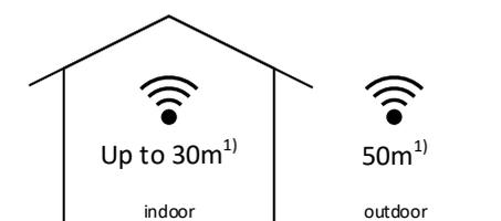
Casambi verwendet die MESH Netzwerk-Technologie. Jedes Gerät verhält sich wie ein Repeater und frischt das empfangene Bluetooth Signal für die folgenden Geräte auf.
