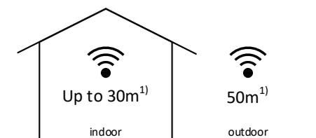
Casambi verwendet die MESH Netzwerk-Technologie. Jedes Gerät verhält sich wie ein Repeater und frischt das empfangene Bluetooth Signal für die folgenden Geräte auf.
