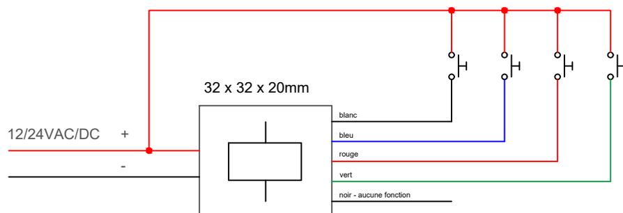
Schéma de connexion: LIGA air module
