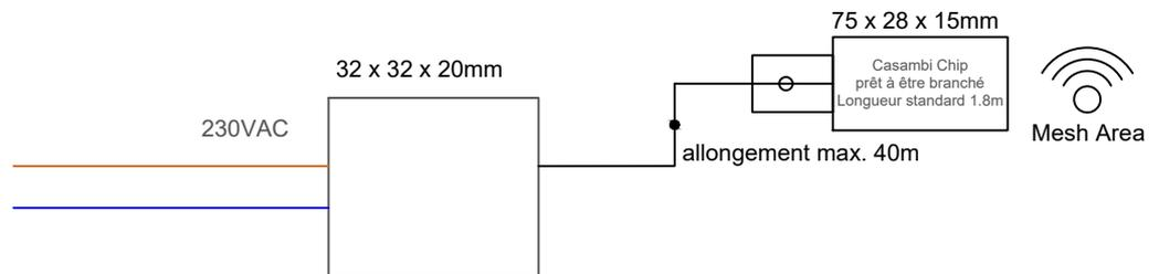
Câble d'extension pour l'antenne :
