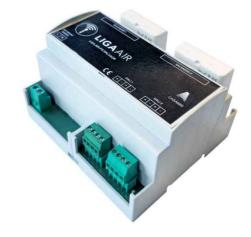
Les broches de contact sont conçues de telle sorte qu'il est possible de les plier pour placer le couvercle de la distribution de manière appropriée.
